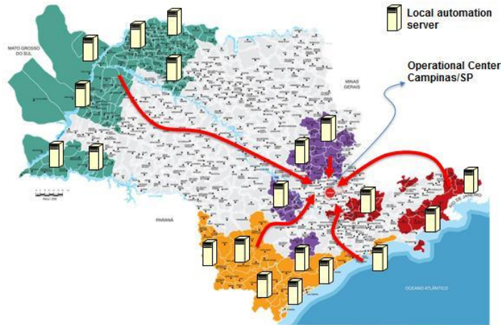
Private Kommunikationsnetze und zentraler Server für Netzautomatisierung (P0183 Brasilien)
